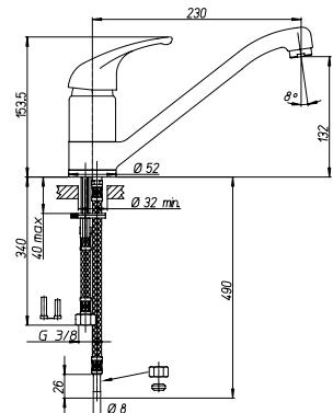
**ESEMPIO DI INSTALLAZIONE IDRAULICO**
