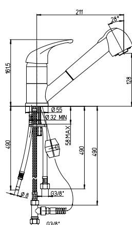
**ESEMPIO DI INSTALLAZIONE IDRAULICO**
