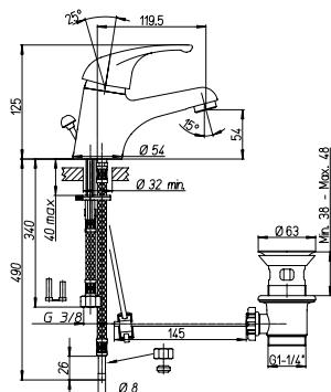
**ESEMPIO DI INSTALLAZIONE IDRAULICO**
